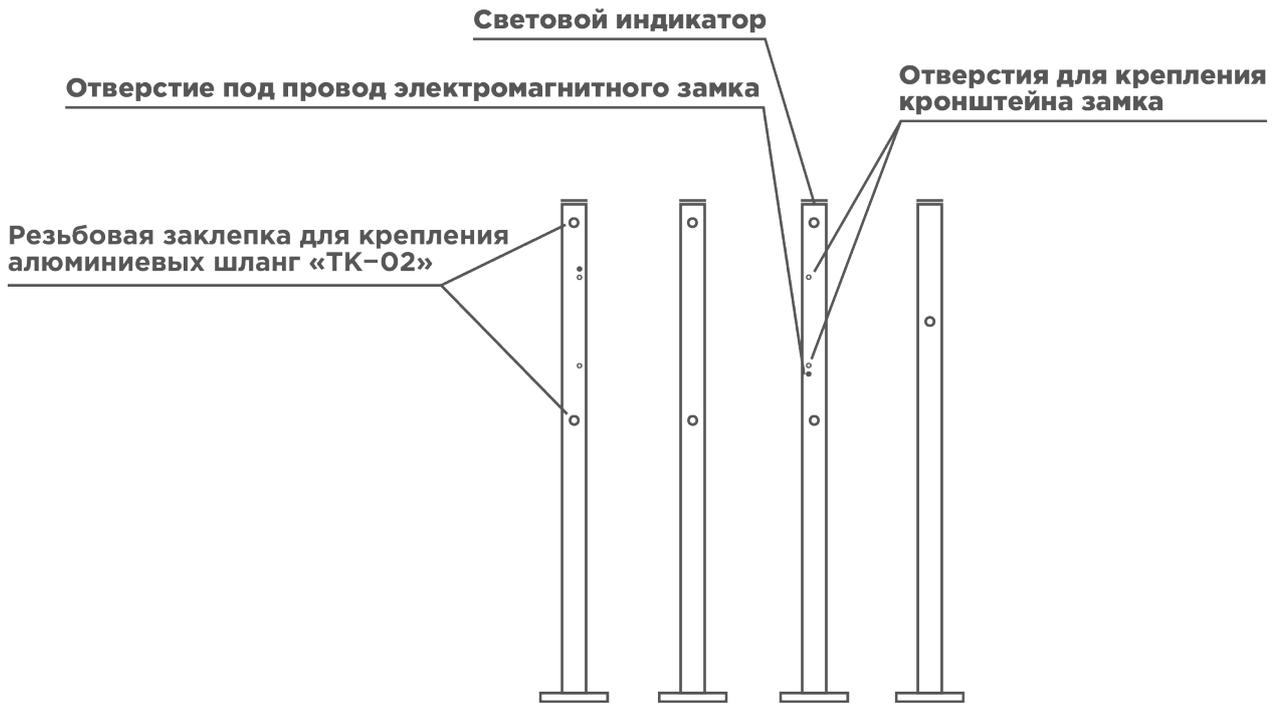
Рисунок 6.1.1. Замковая стойка «RTA-02»
